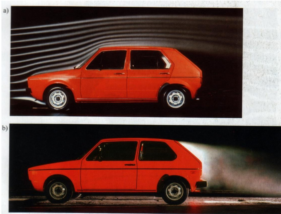
Sichtbarmachung des Strömungsfeldes am VW-Golf 1
