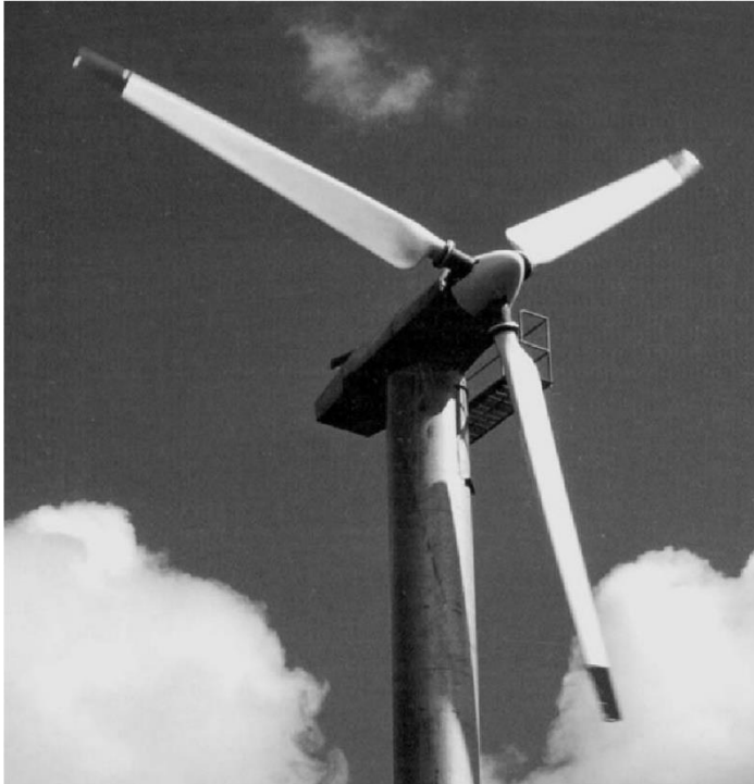
Typische dänische WKA mit 3-Blattrotor ohne Einstellwinkelverstellung
